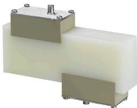
Figure 17 Capteurs sur le bloc de test
