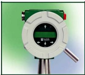
Le débitmètre Vortex multivariable Pro-V™ M24 de VorTek Instruments offre un débitmètre précis et fiable dans une conception multivariable. La conception multivariable incorpore un capteur de vitesse de haute précision, un capteur de température RTD de platine de précision et un transducteur de pression à l'état solide. Le M24 peut fournir des mesures de débit volumétrique, de débit massique, de température, de pression, de densité et d'énergie (BTU)
