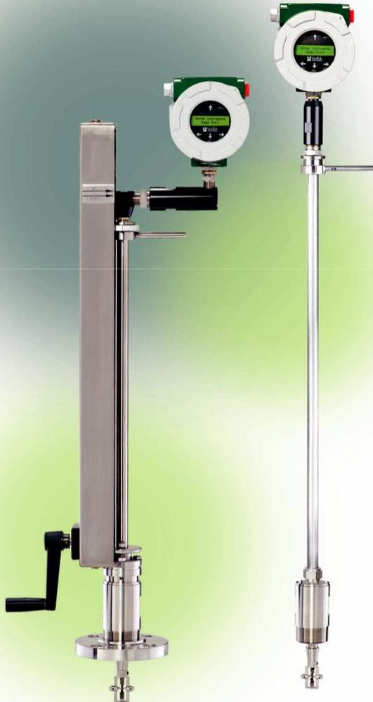
Les débitmètres multivariables Model Pro-T™ de VorTek Instruments utilisent trois éléments de détection primaires (un capteur à turbine, un capteur de température RTD et un capteur de pression à l'état solide) pour mesurer le débit massique de gaz, de liquides et de vapeur. Parce qu'il est capable de mesurer toutes les variables de processus dans un seul appareil, le TurboPro™ offre une précision exceptionnelle, simplifie
